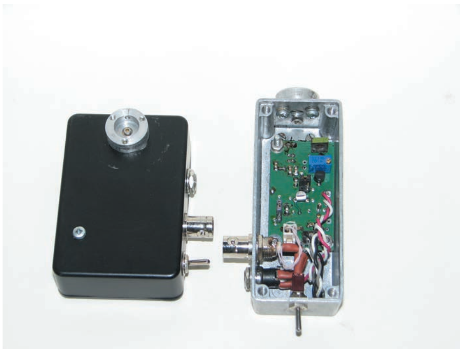
Рис. 4. Пикосекундные диодные лазеры в двух компоновках (один из блоков для наглядности изображен со снятой боковой крышкой).
