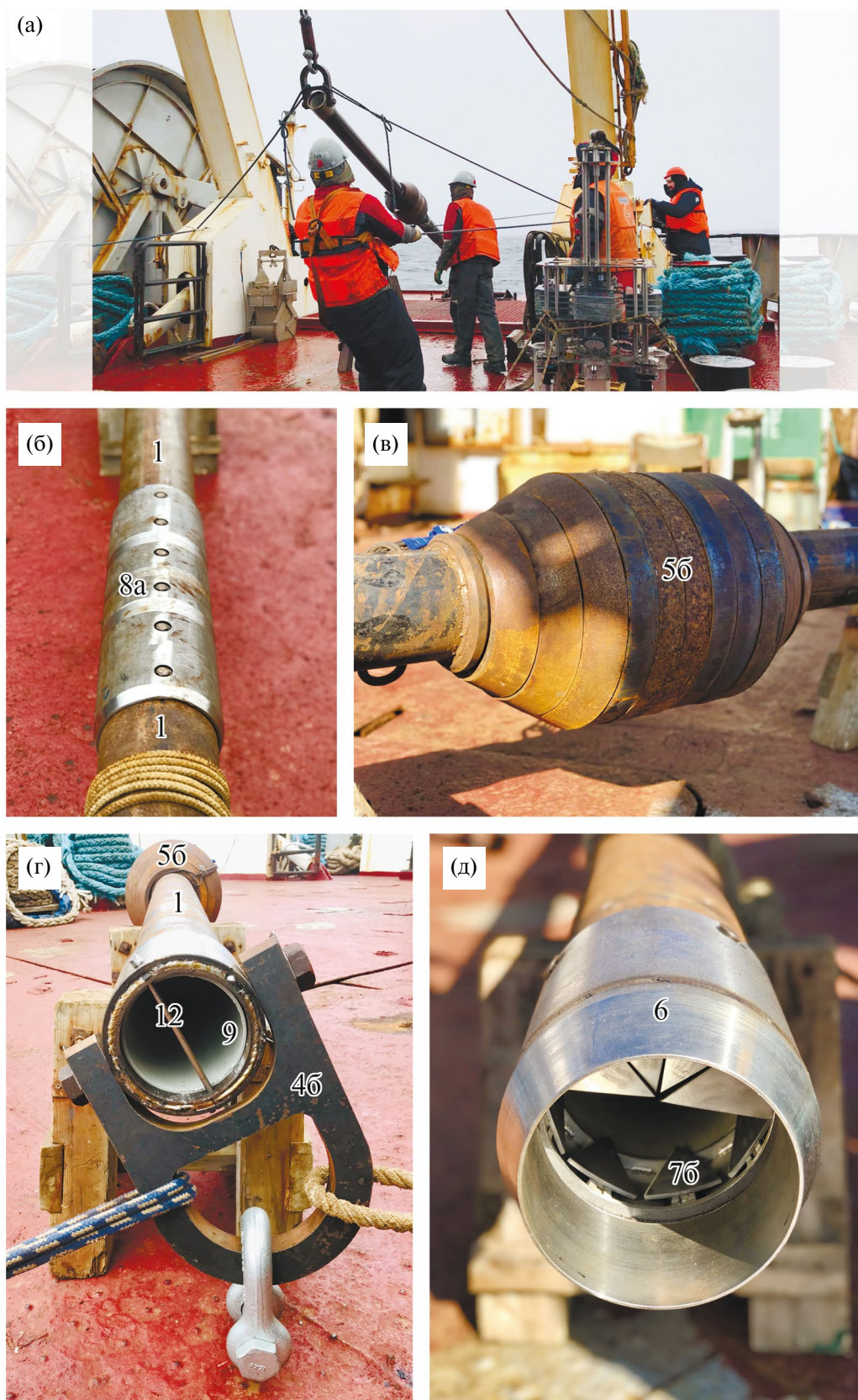
Рис. 2. Общий вид модифицированной гравитационной грунтовой трубки (а) и ее отдельных элементов (б–д) в условиях морской экспедиции. Цифровые обозначения – см. подпись к рис. 1.
