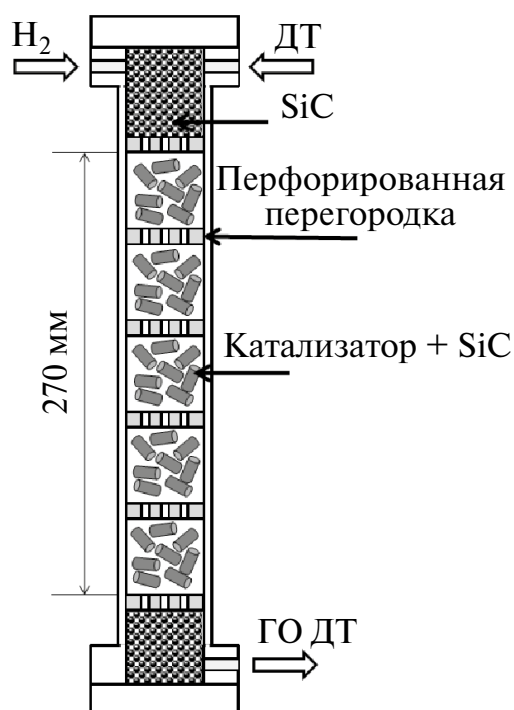
Рис. 1. Принципиальная схема реактора.
