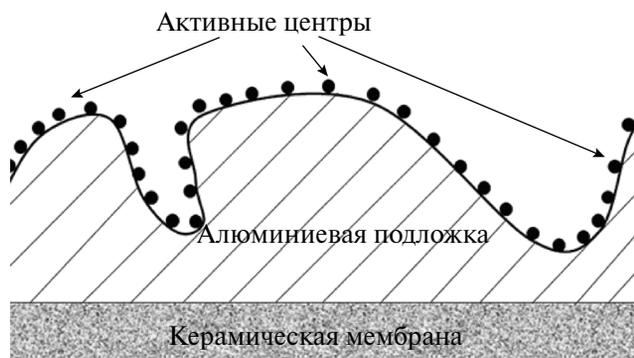
Рис. 17. Каталитические центры, распределенные по поверхности носителя.
