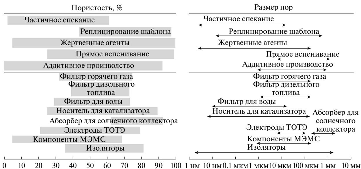
Рис. 14. Данные по пористости (отмечено цветом) и распределению пор (стрелки) по размерам в пористых керамических материалах для различных технологий изготовления и областей применения.
