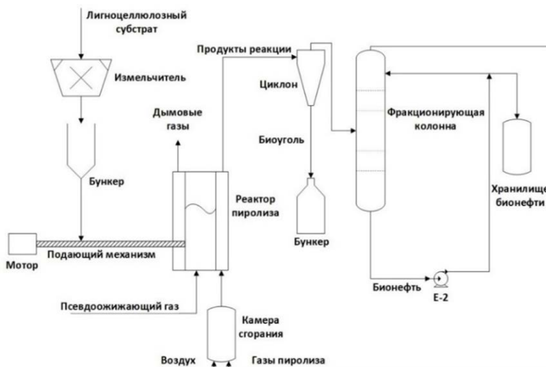
Рис. 1. Технологическое оформление пиролиза лигноцеллюлозного сырья в реакторе с псевдоожиженным слоем [45].
