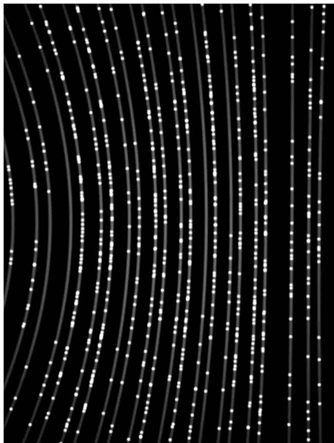
Рис. 3. Результат калибровки положения детектора D = 109 мм, 2\theta_D = -70^\circ дифрактометра Bruker D8 Venture по результатам съемки внешнего эталона Si. Использована программа SearchXY-2 \theta . Показаны только K_{\alpha 1} -составляющие рефлексов, задействованные в итоговом уточнении положения детектора.
