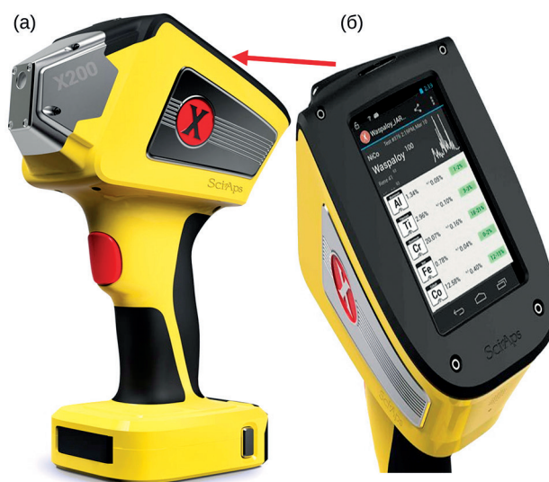
Рис. 4. Внешний вид рентгенофлуоресцентного анализатора SciApsX-200.
