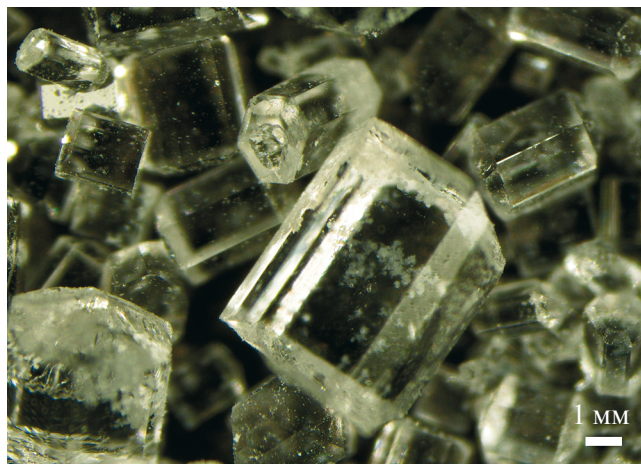
Рис. 1. Фотографии выращенных кристаллов \text{Na}_2\text{SiF}_6 .
