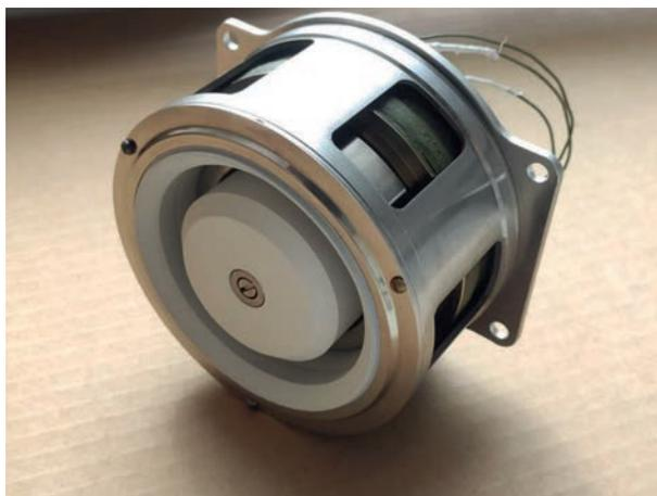
Рис. 1. Модель двигателя СПД-70.
