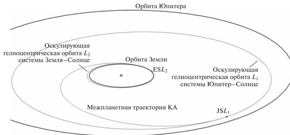
Рис. 1. Схема межпланетного перелета КА с малой тягой между точками либрации  $ESL_2$  и  $JSL_1$ .
