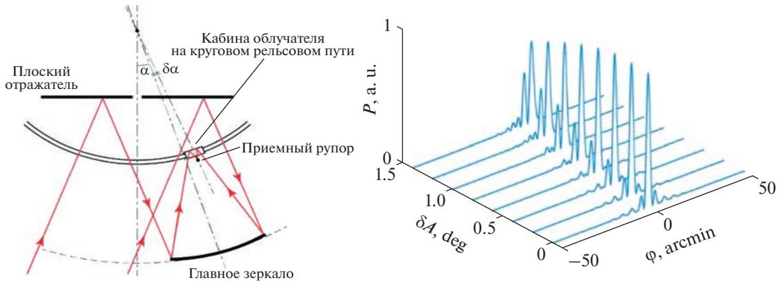
**Рис. 4.** Режим сопровождения на РАТАН-600. Слева: схема движения приемной кабины по дуговым рельсам в азимутальной системе главного зеркала и Плоского отражателя; справа: диаграммы системы Юг + Плоский при различных значениях выноса зеркала приемной кабины из фокуса.
