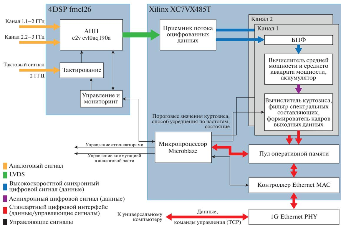
Рис. 2. Схема цифровой части спектрального комплекса.
