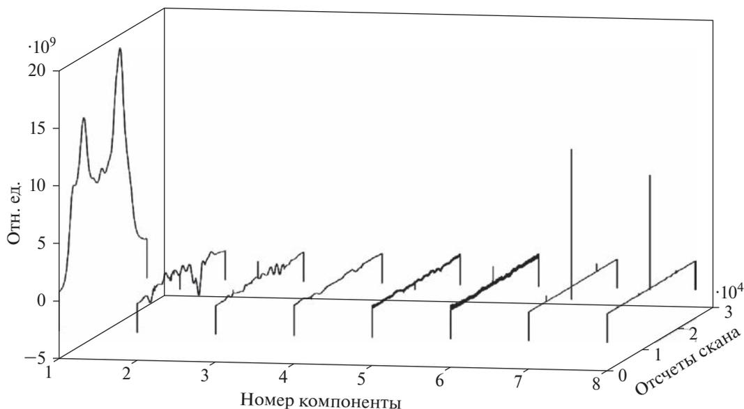
**Рис. 3.** Разложение одномерного скана диска Солнца по нескольким главным компонентам. Ось  $X$  – отсчеты скана, ось  $Y$  – номера компонент, ось  $Z$  – относительные амплитуды в безразмерных единицах.
