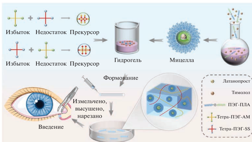
Рис. 11. Стадии разработки глазного имплантата на основе 4-лучевых ПЭГ, смешанного с мицеллами ПЭГ-ПЛА, адаптировано из работы [54].
