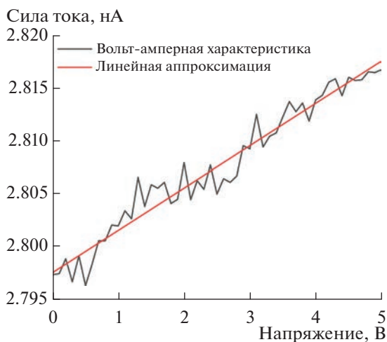
Рис. 3. Темновая вольт-амперная характеристика полученного образца (черный) и линейная аппроксимация полученной характеристики (красный).
