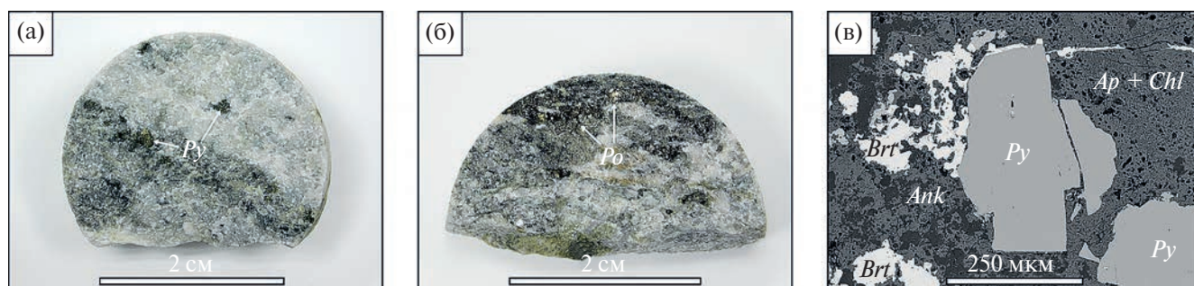
Рис. 2. (а) Пирит в кальцитовом карбонатите массива Контозеро. (б) Пирит в кальцитовом карбонатите массива Себлявр. (в) Барит в ассоциации с пиритом из анкеритового карбонатита (эксплозивной брекчи) массива Салланлатва, изображение в обратно рассеянных электронах. Аббревиатуры: Ap — апатит, Brt — барит, Chl — хлорит, Po — пирротин, Py — пирит.
