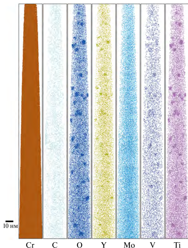
Рис. 4. Атомные карты распределения химических элементов в исследованном объеме стали 10Cr ODS после старения при 650°C в течение 500 ч.
