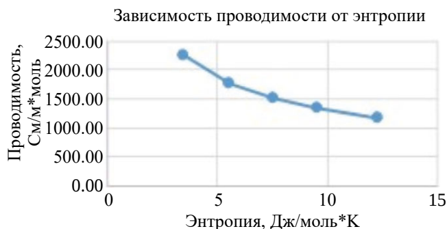
Рис. 15. Зависимость поверхностной электропроводимости от величины энтропии.
