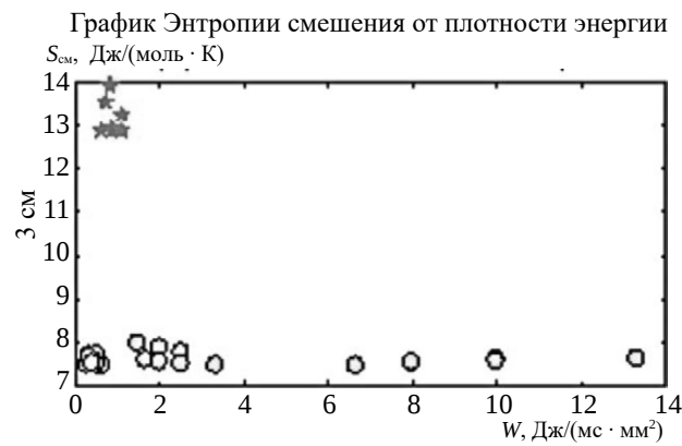
Рис. 12. Зависимость энтропии S_{см} смешения от плотности лазерной энергии W , где круги обозначают отсутствие дендритов на поверхности образца, а звездочки — их наличие.
