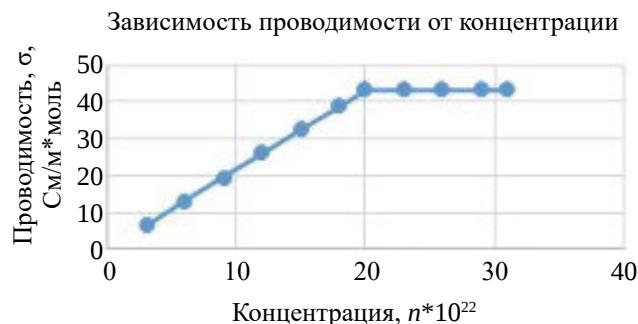
Рис. 13. Зависимость электропроводимости от концентрации носителей заряда.
