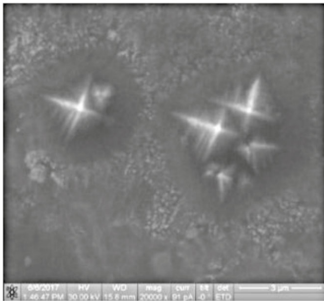
Рис. 10. Дендриты на поверхности образцов стали — показан один из снимков РЭМ: слева — одиночный дендрит, справа — ансамбль дендритов.
