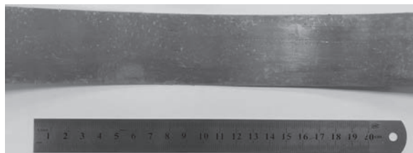
Рис. 1. Экспериментальный сплав Al_{2.5}Ca_{2.5}Mg в горячекатаном состоянии.
