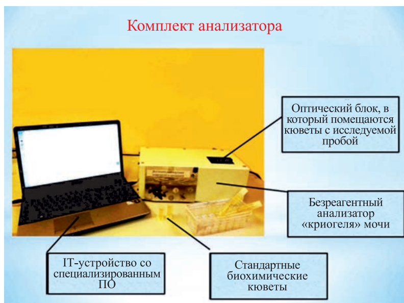
Рис. 4. Макет анализатора «Уроскрин».
