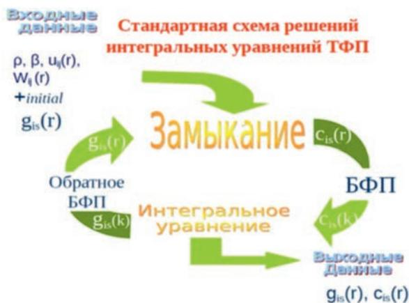
Рис. 1. Стандартная численная схема решений интегральных уравнений теории классического функционала атомной плотности для молекулярной жидкости (ТФП – теория функционала плотности, БФП – быстрое Фурье-преобразование).
