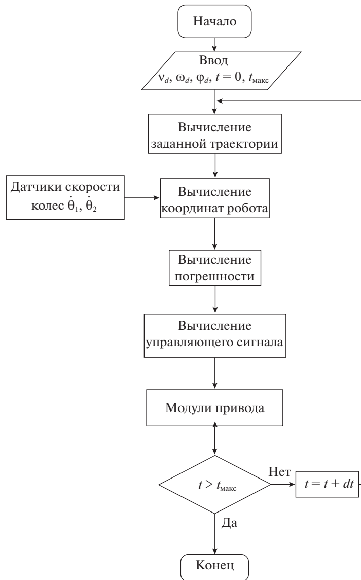
Рис. 8. Блок-схема алгоритма управления колесным роботом на первом этапе
