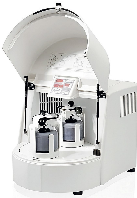
Рис. 2. Планетарная шаровая мельница Fritsch GmbH Pulverisette-7.
