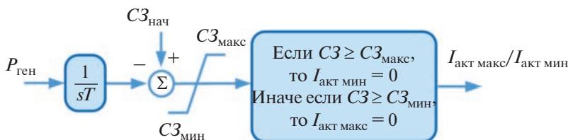
Рис. 6. Контур заряда-разряда в обобщенной модели АБ.
