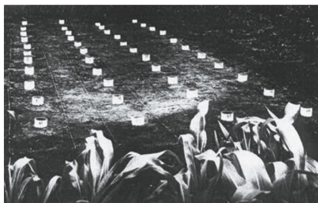
Рис. 4. Общий вид площадки для определения эмиссии CO_2 парующейся почвой на микроделянках (сосуды-изоляторы со снятыми крышками в промежутках между измерениями) [76].
